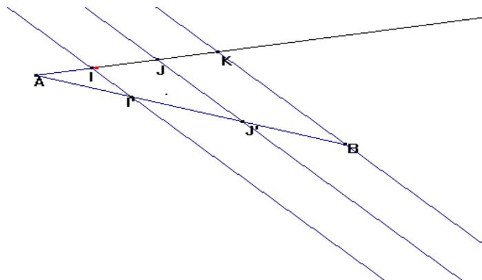
Pour cet exemple, on a tracé une demi-droite d'origine A. On prend un écartement quelconque du compas et on marque 3 points équidistants I, J et K sur cette demi-droite ( $AI = IJ = JK$ ). On trace la droite passant par K et B. Ensuite on trace la droite passant par J et parallèle à la droite (KB) qui coupe  $[AB]$  en  $J'$  et celle passant par I et toujours parallèle à (KB) qui coupe  $[AB]$  en  $I'$
