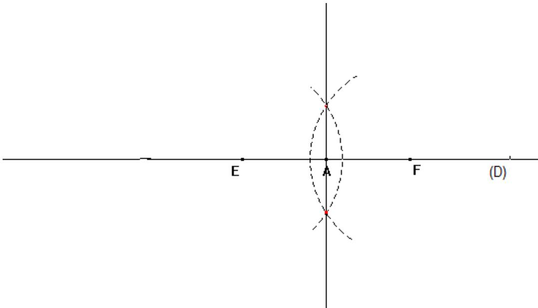
Avec le compas on place deux points E et F équidistants de A. On trace un arc de cercle de centre E et de rayon supérieur à EA. En gardant le même écartement, on trace l'arc de centre F et de même rayon. Ces deux arcs se coupent en deux points. La droite passant par ces deux points passe par A et est perpendiculaire à (D)
