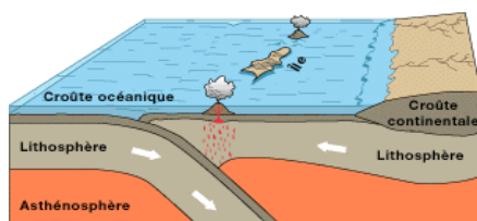
Rapprochement de deux plaques océaniques avec passage de l'une sous l'autre: Subduction
