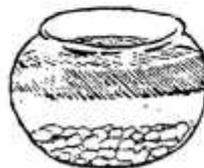
6- Placer le pot servant de filtre sur le deuxième pot et verser l'eau. L'eau devra être versée lentement pour ne pas déranger et mélanger les couches de charbon de bois et de sable.
