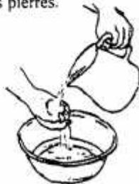
3- Tamiser le sable pour enlever les impuretés et le rendre homogène.
